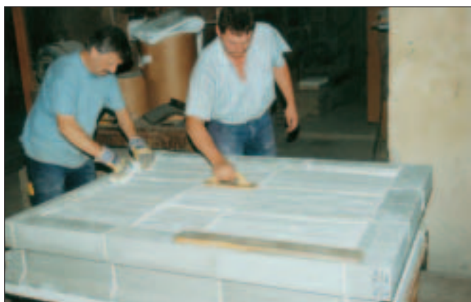
Umbau von Tunnelofenwagen in Leichtbauweise
