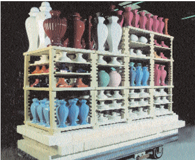
Flexibler Ofenwagenaufbau mit Cordierit-Zahnstützen und Einschubplatten
