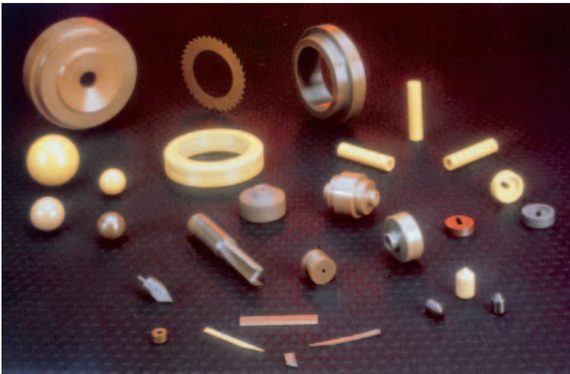
Komponenten aus Hochleistungskeramiken (hier Zirkonoxid und Siliziumnitrid)
