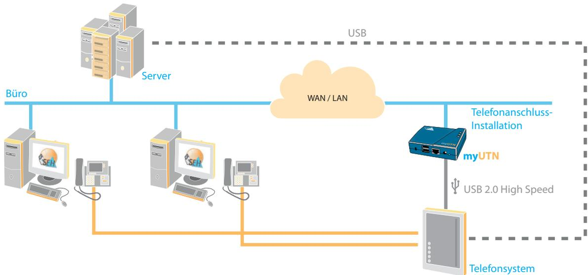
Mit einem myUTN USB Device Server lässt sich die Telefonanlage einfach ans Netz anschließen und die räumliche Entfernung ist schnell und einfach überbrückt. Das Wählen per Mausklick am PC wird auf diese Weise ganz leicht gemacht.
