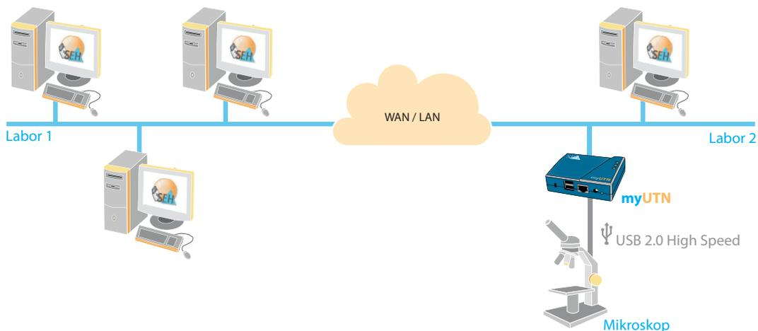
Ein Zugriff auf die Daten eines solchen Mikroskops oder ähnlichen Laborgerätes von verschiedenen PCs im Netzwerk ist daher sehr praktisch. Auch hier überbrückt ein myUTN USB Device Server die räumliche Distanz und erleichtert den mobilen und flexiblen Einsatz dieser Geräte.
