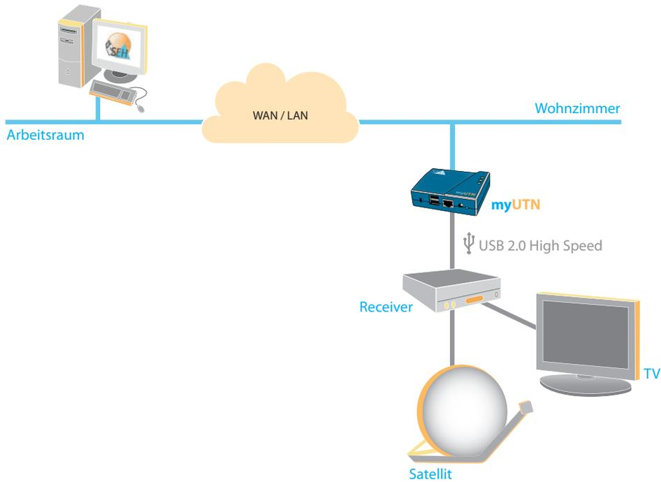
Wird die TV-Set-Top-Box über einen myUTN USB Device Server mit dem Netzwerk verbunden, kann der Anwender sie direkt und bequem ohne räumliche Einschränkungen über das Netz ansteuern.
